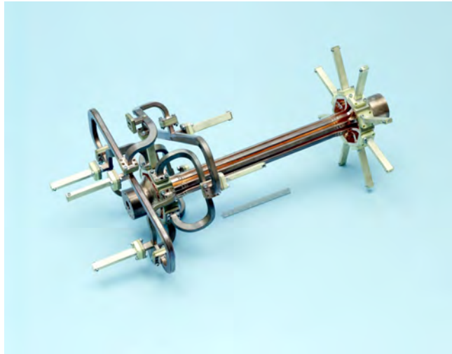
Fig. 8-17. Ka-band monopulse coupler.
